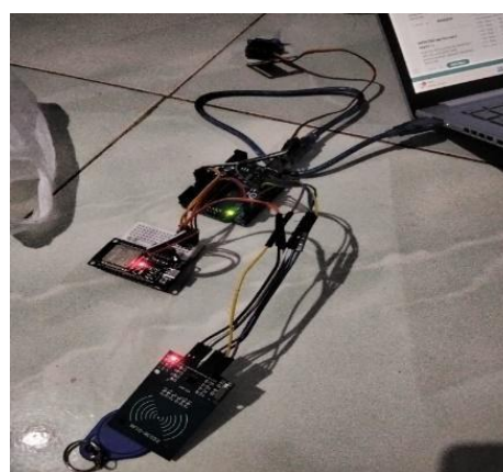
Gambar 4. Perakitan Modul RFID RC522 dengan ESP32
